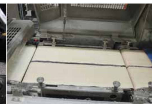
Das gravimetrische System In die Transportbänder sind zwei Waagen integriert, die das Gewicht exakt ermitteln.
