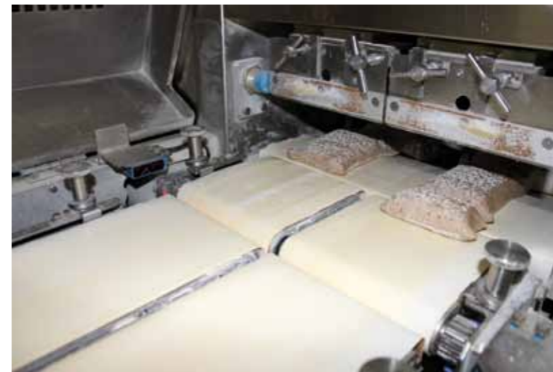
Exaktes Gewicht: Beim Twin Divider verfügt jedes Transportband über das integrierte Wiegesystem mit zwei Waagen.
