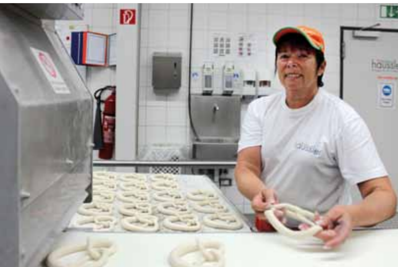
Hohe Rationalisierung: Nur das Absetzen der Teiglinge erfolgt manuell.
