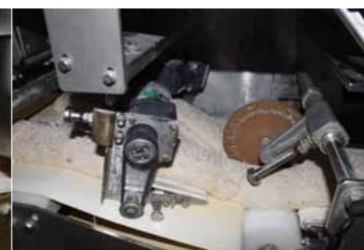
Mit einem Rundmesser schneidet der Twin-Divider 2 Reihen, bevor die Guillotine einzelne Teigstücke präzise abwägt.
