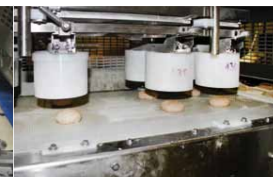
Wie von Hand Der Cup Rounder setzt wie die menschliche Hand von Oben auf und schleift das Teigstück ohne Druck rund.
